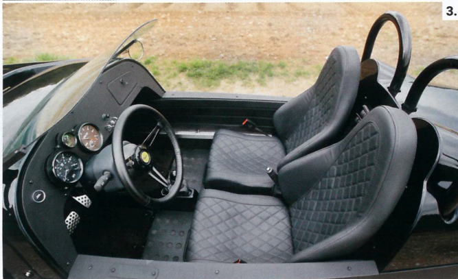
1. Dreirad richtig herum: Der Umstand, mit nur drei Rädern unterwegs zu sein, ist kaum spürbar. 2. Minimalistisch: Die Hinterradschwinge wird von einem einzelnen Federbein in Zaum gehalten. 3. Akzeptabel: Dank Frontantrieb zwingt sich kein Antriebsstrang zwischen die nahe sitzenden Passagiere. 4. Narrensicher: Die aufwendige Vorderachse bewahrt selbst forsche Piloten vor dem Unglück. 5. Auffällig: Der Vanderhall ist exhibitionistisch auffällig und setzt einiges an Extrovertiertheit voraus.
