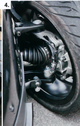
1. Dreirad richtig herum: Der Umstand, mit nur drei Rädern unterwegs zu sein, ist kaum spürbar. 2. Minimalistisch: Die Hinterradschwinge wird von einem einzelnen Federbein in Zaum gehalten. 3. Akzeptabel: Dank Frontantrieb zwingt sich kein Antriebsstrang zwischen die nahe sitzenden Passagiere. 4. Narrensicher: Die aufwendige Vorderachse bewahrt selbst forsche Piloten vor dem Unglück. 5. Auffällig: Der Vanderhall ist exhibitionistisch auffällig und setzt einiges an Extrovertiertheit voraus.
