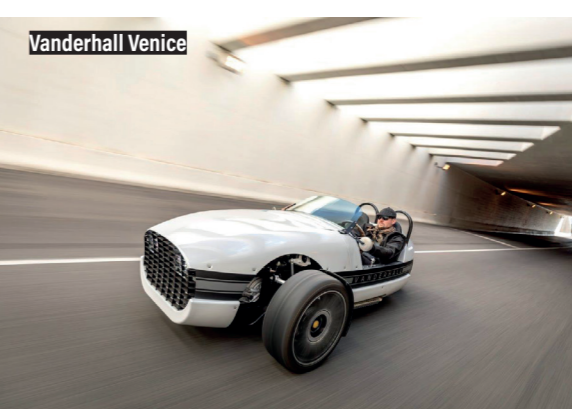
Das breite, mittig platzierte Hinterrad gibt viel Grip in Kurven.
